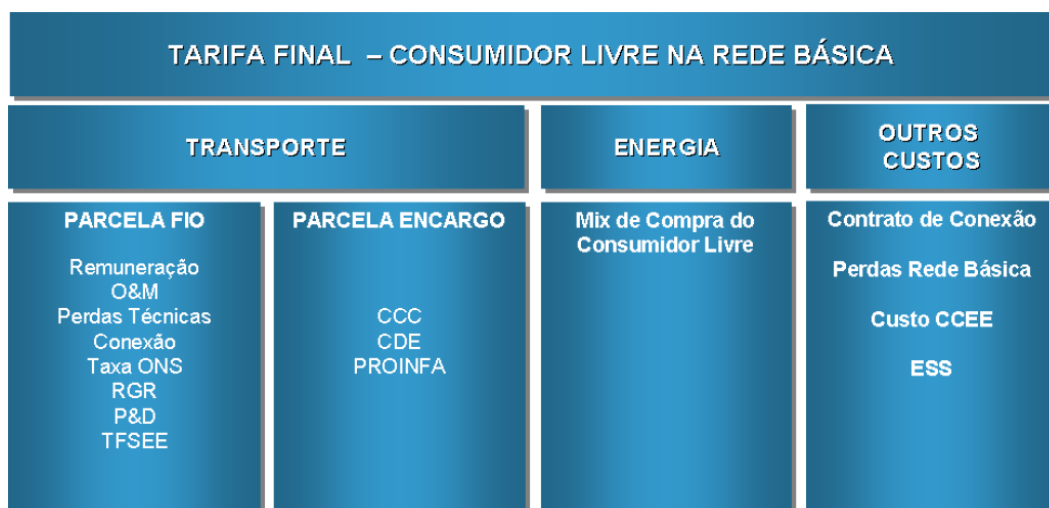
Figura 4: Componentes da tarifa global de consumidor livre com acesso direto à Rede Básica com discriminação de elementos excetuados os impostos
